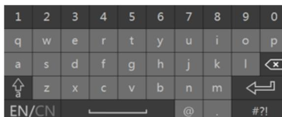
O sistema inclui duas caixas de entrada. Consulte as fotos acima. A caixa da esquerda é a caixa de entrada de número e a caixa da direita é a caixa de entrada que fornece entradas de números, letras e caracteres de pontuação. As introduções de teclas nas caixas de entrada são mostradas abaixo.
