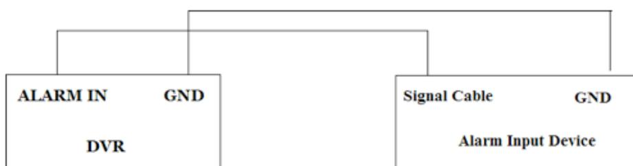
A entrada de alarme é um relé aberto / fechado. Se a entrada não for um relé aberto / fechado, consulte o seguinte diagrama de conexão:
